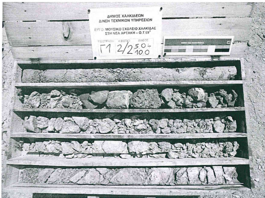
Φωτ. 2: Δείγματα γεώτρησης Γ1. Βάθος 5,0 m – 10,0 m
