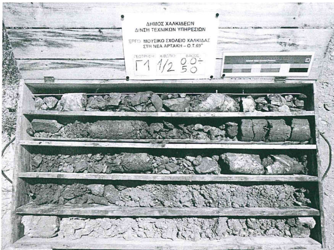
Φωτ. 1: Δείγματα γεώτρησης Γ1. Βάθος 0,0 m – 5,0 m
