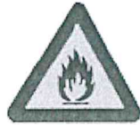
Εύφλεκτες ύλες ή/ και υψηλή θερμοκρασία
